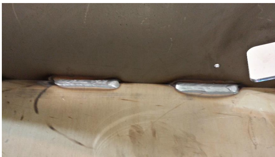
Fotografia 12. Cordão de solda realizado pela Lincoln Power Wave .
