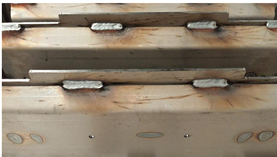
Fotografia 5. Cordão de solda realizado na linha antiga.
