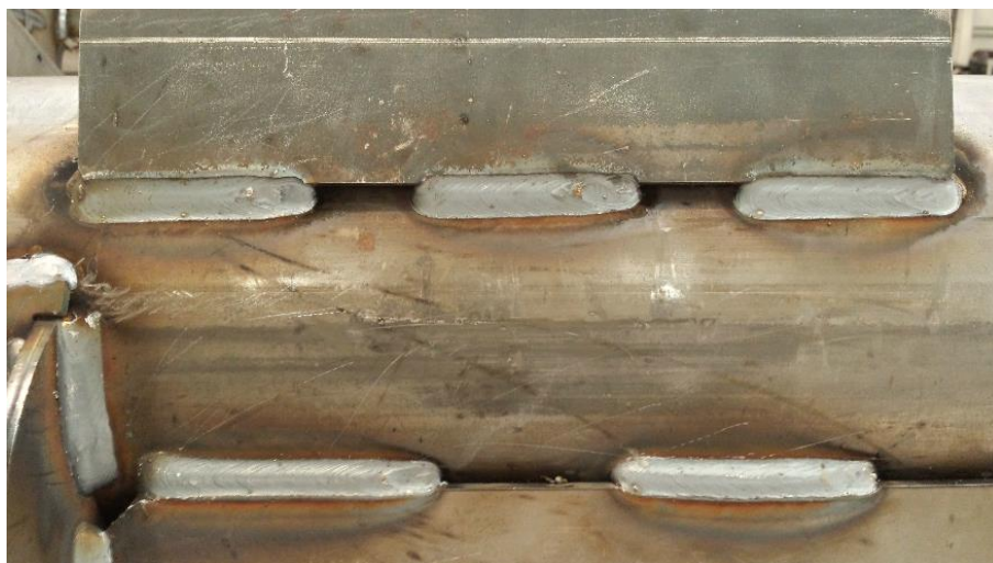
Fotografia 9. Cordão de solda realizado pela Lincoln Power Wave .
