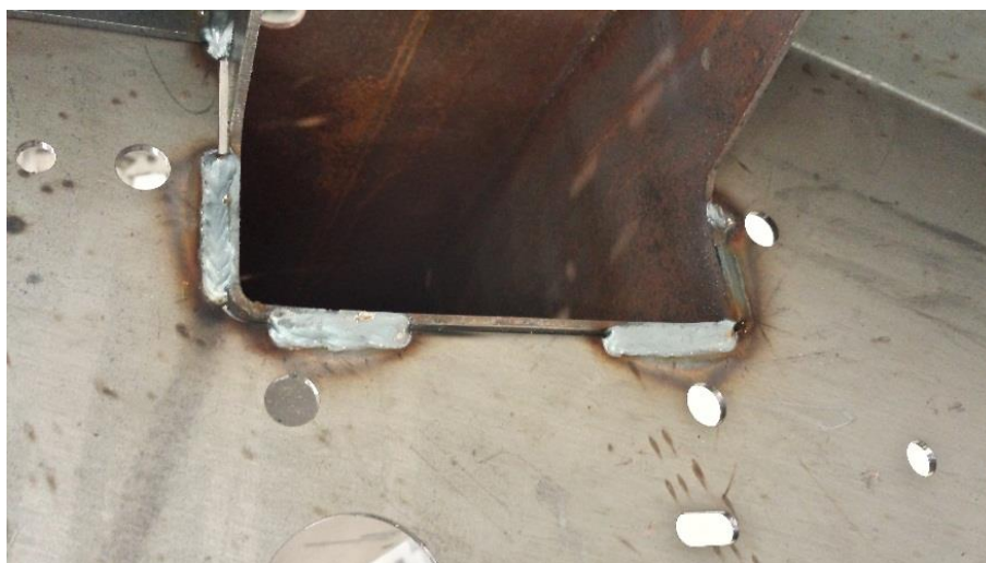
Fotografia 10. Cordão de solda realizado pela Lincoln Power Wave .
