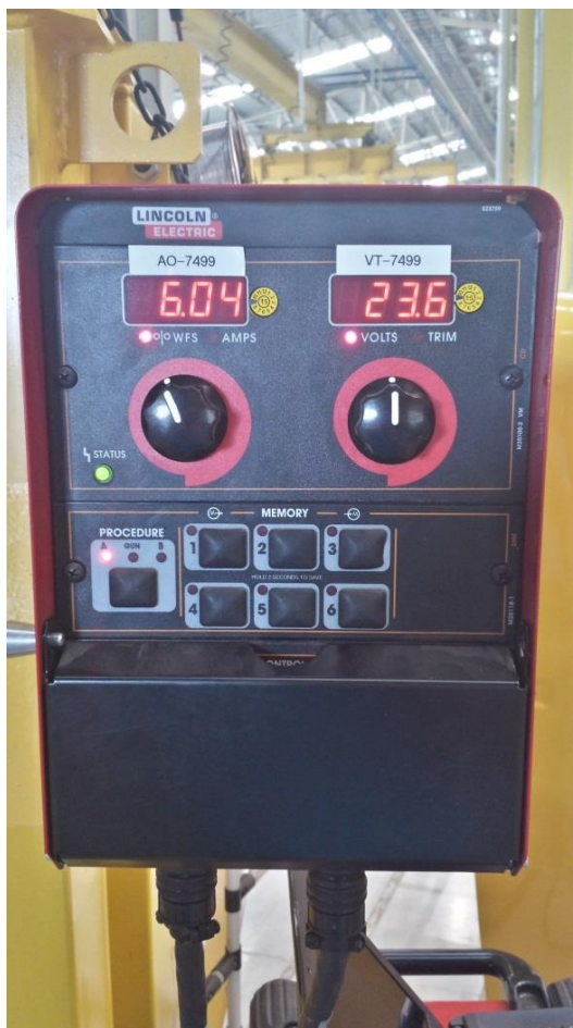
Fotografia 3. Painel da máquina na linha nova indicando os parâmetros selecionados.
