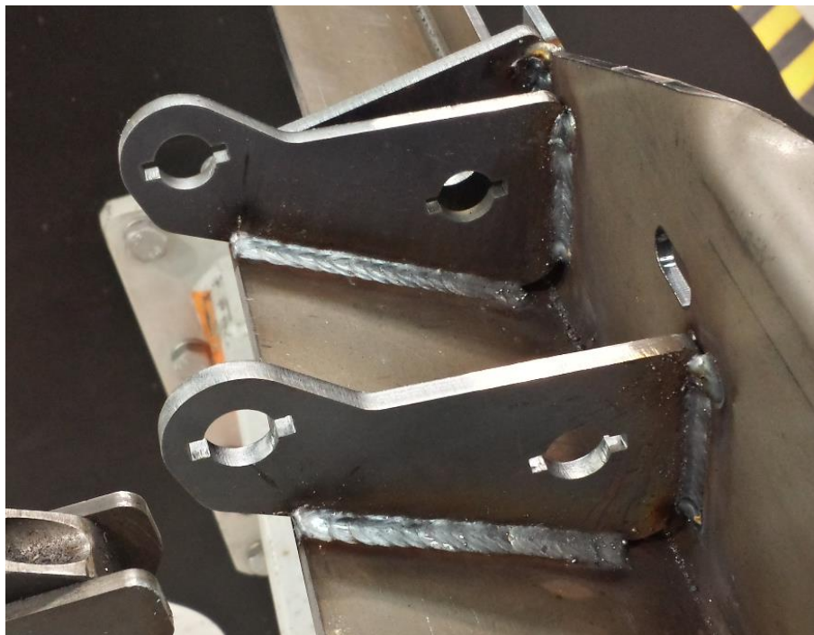
Fotografia 11. Cordão de solda realizado pela Lincoln Power Wave .
