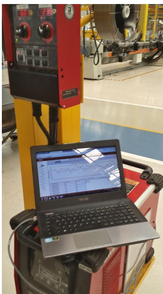
Fotografia 2. Notebook em conexão com a máquina e recebendo os dados.
