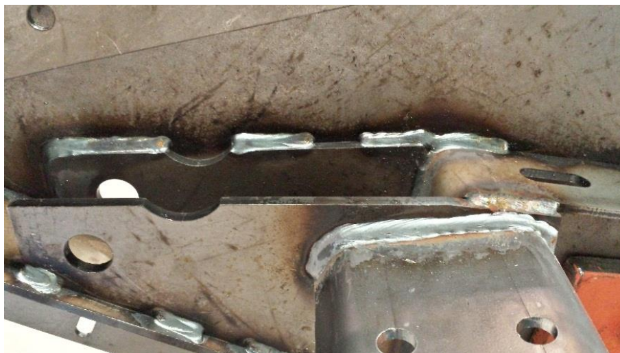
Fotografia 7. Cordão de solda realizado na linha antiga.
