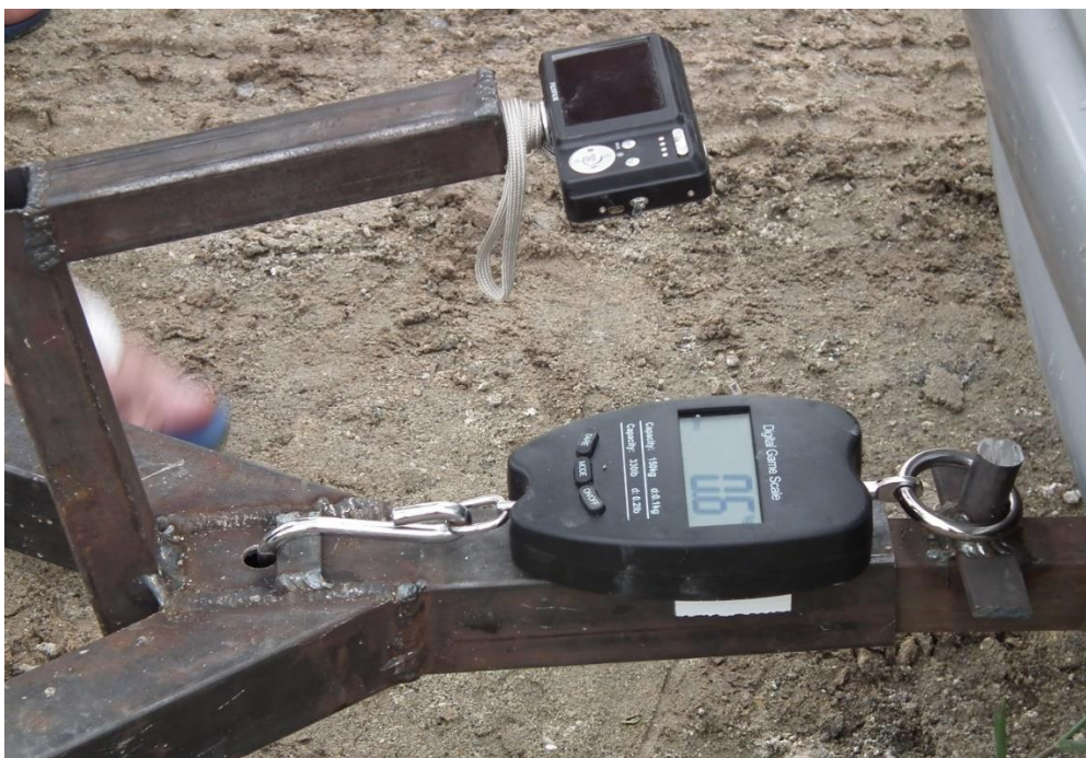
Figura 3.3 - Acoplamento do trenó com o veículo e sistema de medição de força.
