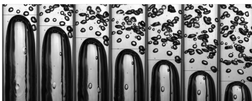
Figura 31 - Sequência de detecção do nariz da bolha alongada.
