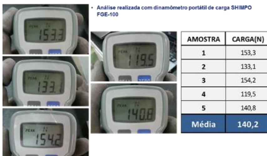
Figura 9 – Força média necessária para tensionamento da corrente
