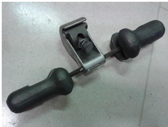
Figura 4.1 - Stockbridge do tipo assimétrico utilizado nos ensaios. Fonte: O AUTOR
