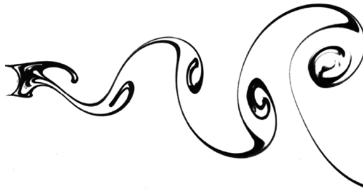
Figura 2.12 - Vórtices de Karman. Fonte: SIMERICS
