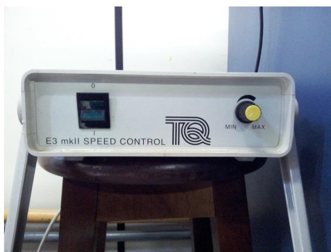
Figura 4.11 - Controlador de velocidade E3 mkII da TecQuipment.
