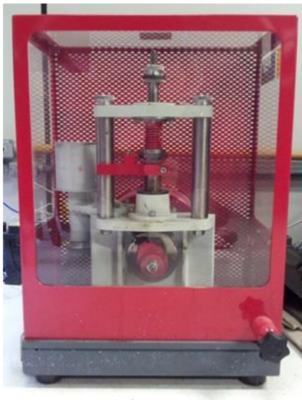
Figura 4.5 – Vista frontal da máquina de came TM21 da TecQuipment. Fonte: O AUTOR
