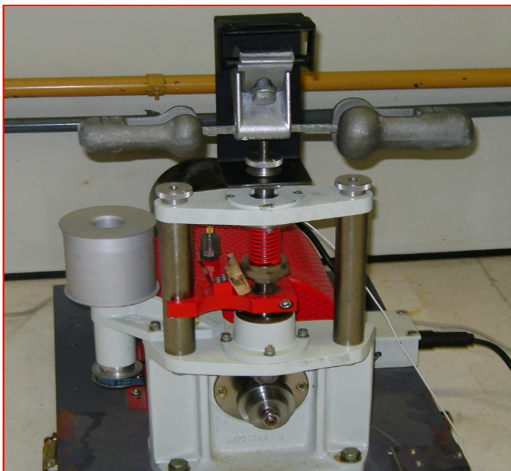
Figura 4.4 - Sistema de deslocamento com amplitude constante e frequência controlada. Fonte: O AUTOR
