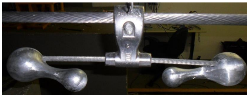
Figura 2.40 - Stockbridge do tipo dogbone. Fonte: SILVA JR (2011)
