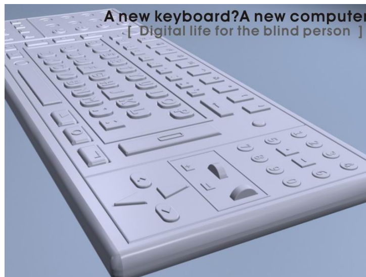
Figura 2: Teclado desenvolvido para deficientes visuais.
