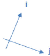
Figura 22: Sistema de Coordenadas móveis i e j que acompanham a barra diagonal
