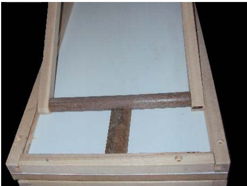
Figura 51: Acionamento dos eixos substituído por barra de madeira
