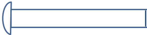
Figura 19: Formato do pino passante utilizado para conectar as barras diagonais e as bases superior e inferior
