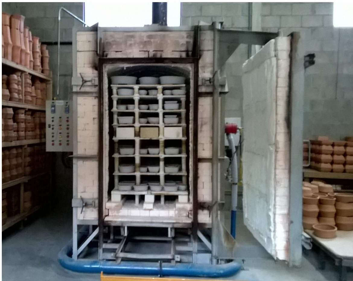
Figura 25 - Forno com carga de peças glazuradas pronta para a queima
