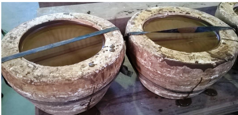
Figura 16 - Barbotina dentro do molde para a formação de parede
