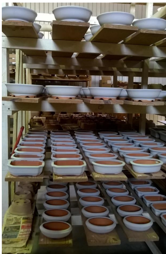
Figura 24 - Peças glazuradas secando no estaleiro
