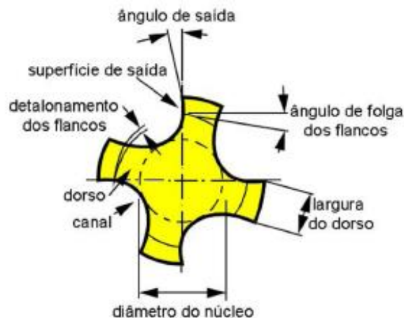
Figura 11 - Corte de um macho de canal reto. Fonte: Pimentel (2009) apud Titex Plus (1999).
