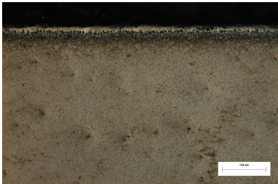
Figura 27 - Microscopia do aço rápido M2 após Boretação III, têmpera ao ar e revenimento. Ataque químico Nital 5%.
