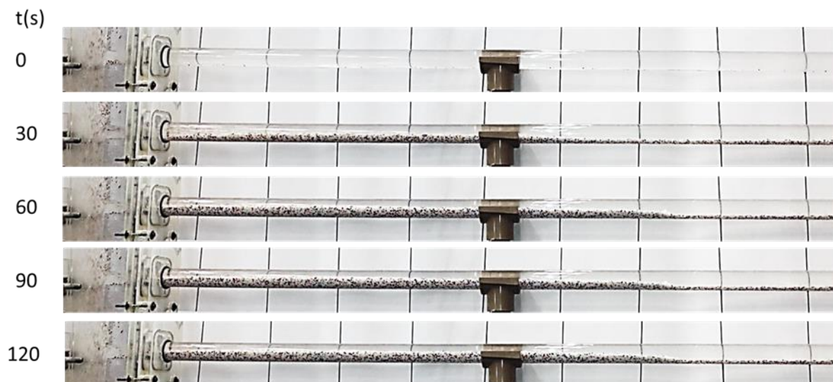
Figura 4.9 - Processo de formação do leito de partículas ao longo tempo para C_p = 3\% , Re = 150 e Q_V = 0,75 .
