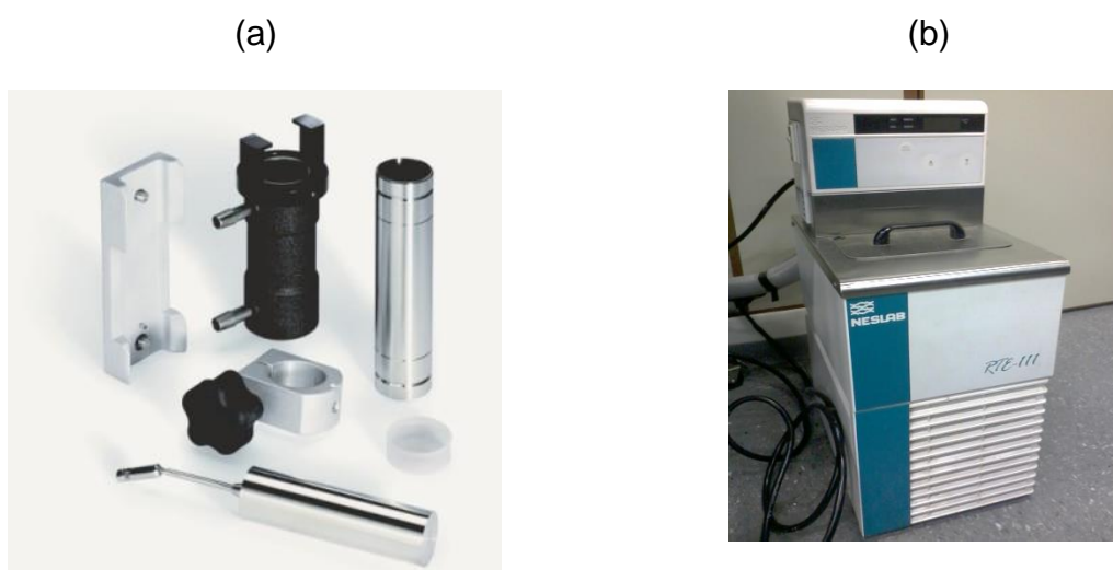
Figura 3.23 – Equipamentos utilizado nos testes reométricos: (a) Adaptador UL; (b) Banho termostático RTE-111.
