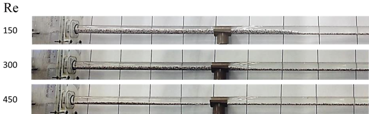
Figura 4.20 - Instantes finais para cada número de Reynolds utilizado no processo de preenchimento da fratura para e_{FR} = 20 mm e Q_v = 0,75 .
