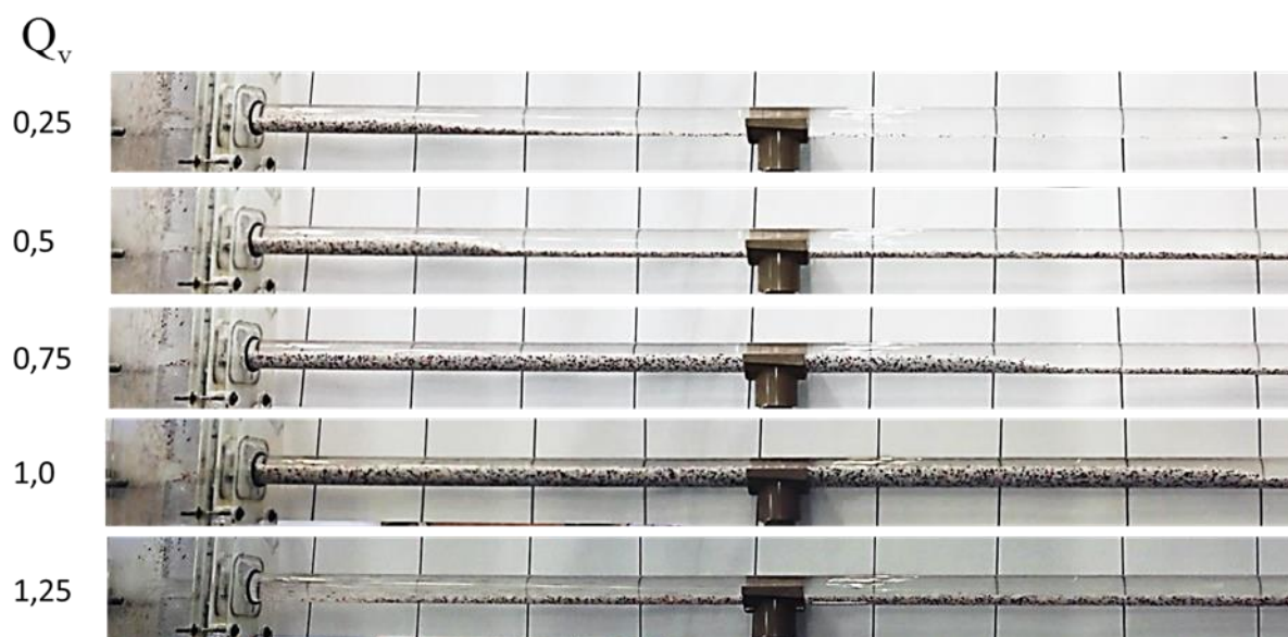
Figura 4.17 - Instantes finais para cada vazão de fuga inicial utilizada no processo de preenchimento da fratura para e_{FR} = 20 mm e Re = 150 .
