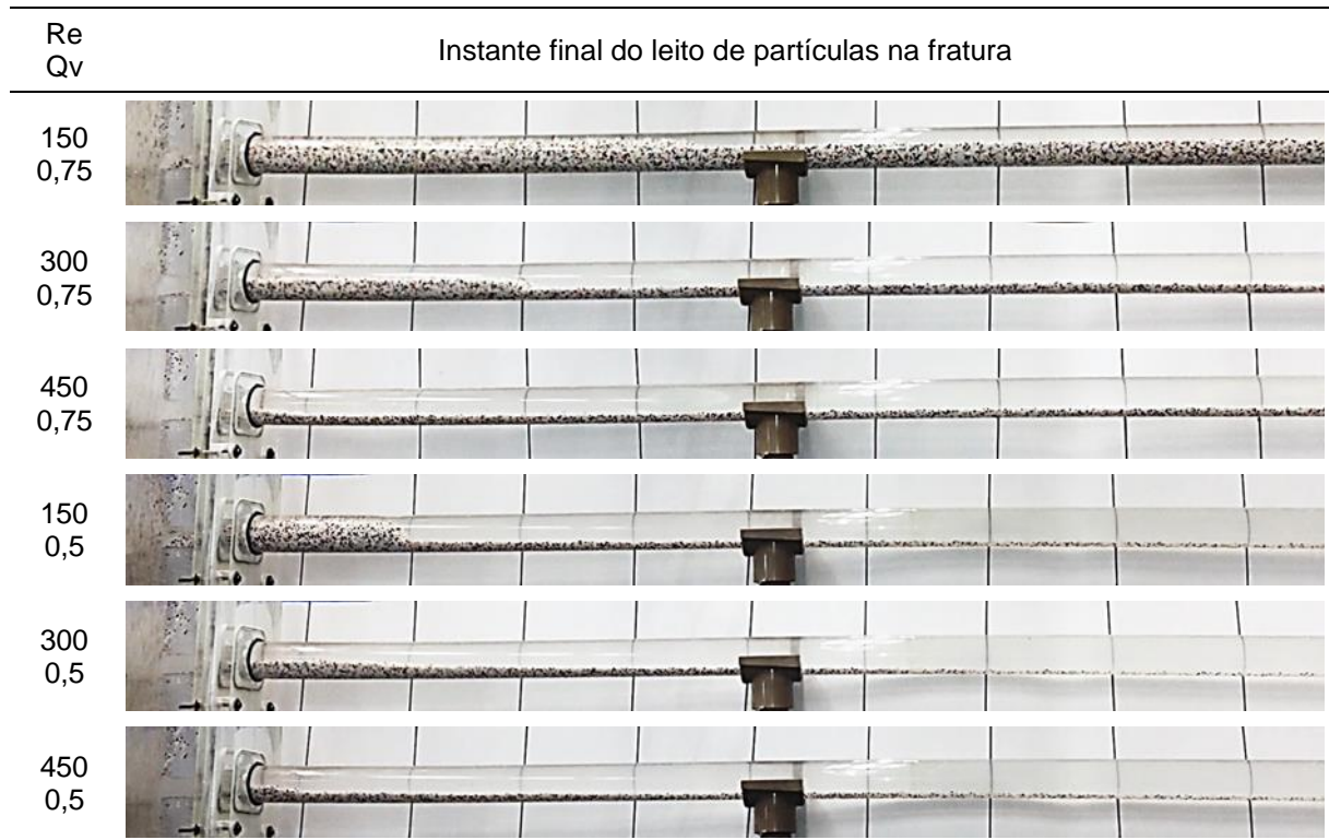
Figura A.3 – Instantes finais do leito de partículas para e_{FR} = 26 mm.
