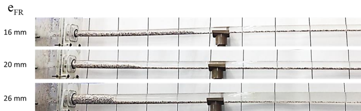
Figura 4.11 - Instantes finais para cada espessura de fratura utilizada no processo de preenchimento para Q_v = 0,5 e Re = 150 .
