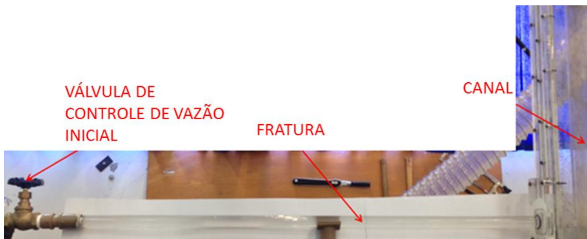
Figura 3.14 - Visão geral da fratura com a válvula de controle de vazão de fluido.
