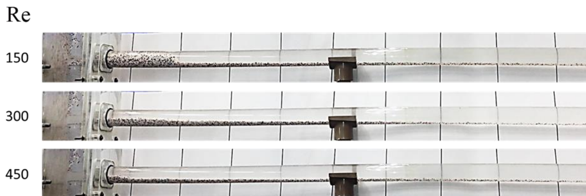
Figura 4.22 - Instantes finais para cada número de Reynolds utilizado no processo de preenchimento da fratura para e_{FR} = 26 mm e Q_V = 0,5 .
