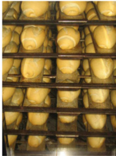
Figura 8. Fotografia de pães assados em forno assistido por termossifão. É possível observar a homogeneidade da cocção pela aparência constante dos pães.
