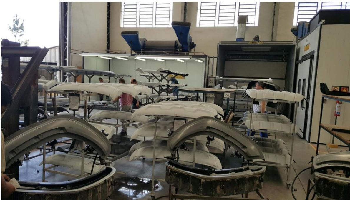
Figura 64 - Aplicação de desmoldante próxima a peças prontas para pintura (peças brancas)
