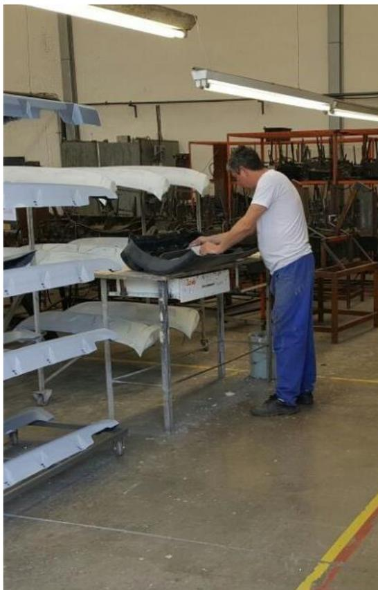
**Figura 41 – Processo de aplicação de massa em uma peça.**
