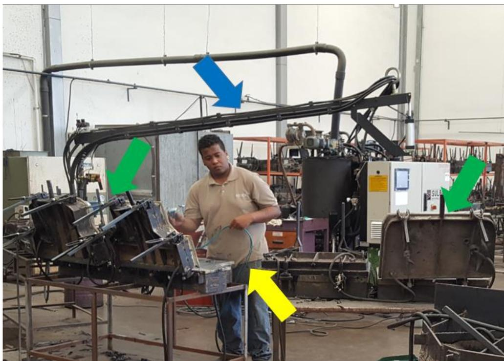
**Figura 52 – Disposição dos moldes ao redor das injetoras**
