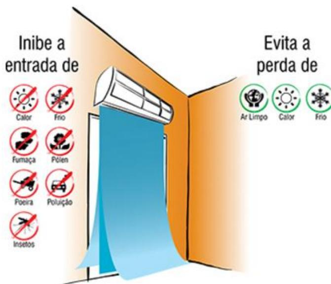
**Figura 37 – Funcionamento da cortina de ar.**
