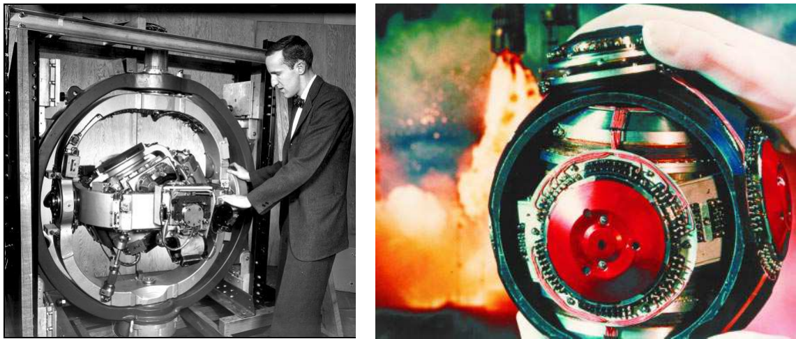
Figura 7 – Evolução dos sistemas gimbaled . A imagem à esquerda é uma foto do sistema SPIRE. A imagem à direita é uma foto da plataforma gimbaled Marconi FIN1000.
