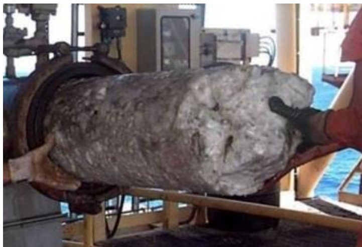
Figura 7: Plugue de hidrato formado em uma linha de escoamento offshore (Fonte: Pinto, 2015).
