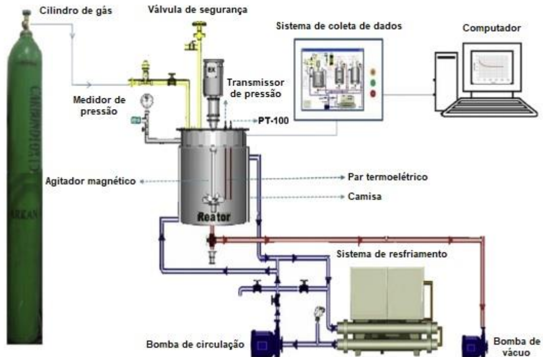
Figura 16: Unidade experimental de formação de hidrato (Fonte: Khosharay et al. , 2015).
