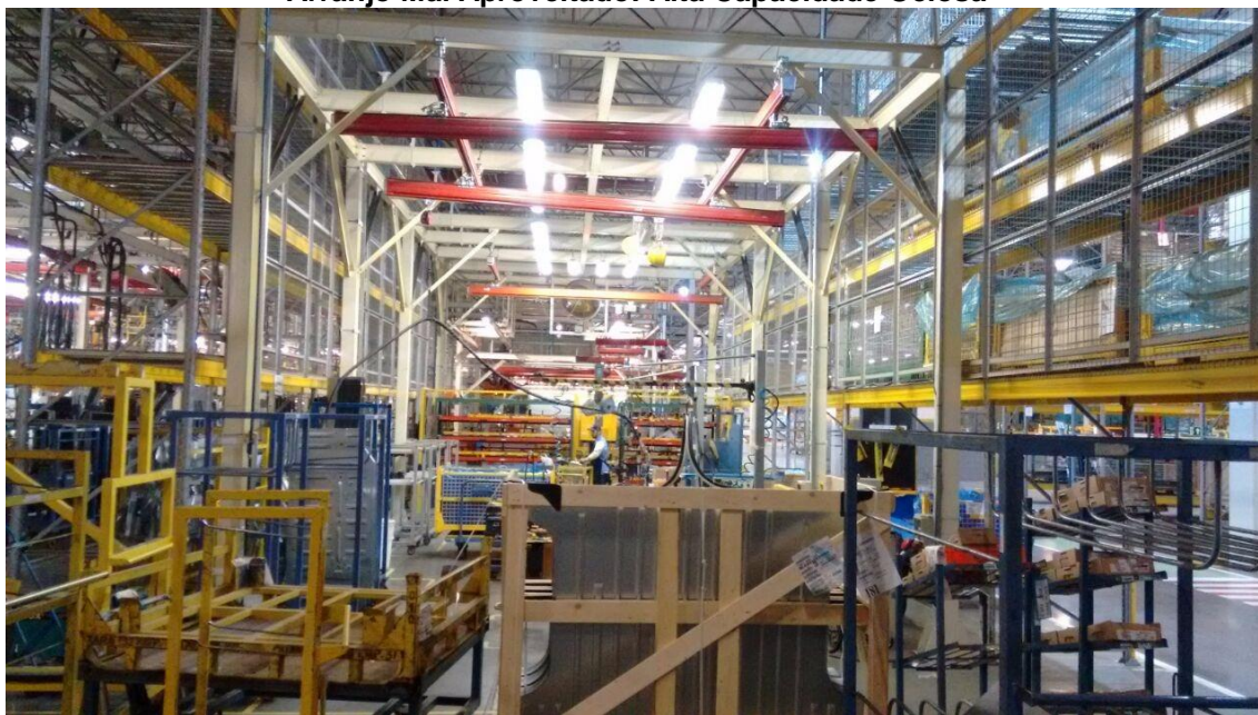
Figura 16 - Layout Atual da Área de Furação. Excesso de Estoque em Borda de Linha e Arranjo Mal Aproveitado: Alta Capacidade Ociosa
