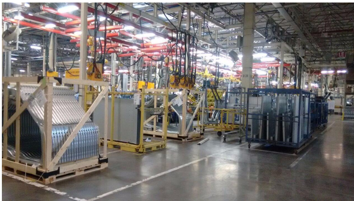
Figura 11 - Layout Poluído Devido ao Volumoso Estoque em Borda de Linha.
