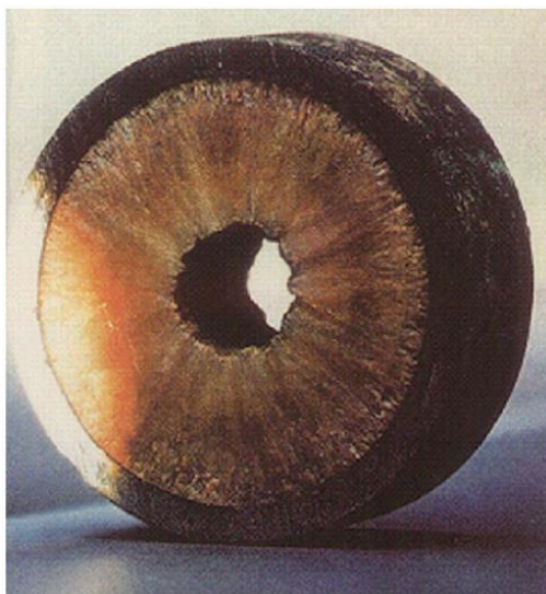
Figura 1 - Seção transversal de tubulação que sofreu deposição de parafinas Fonte: Venkatesan (2005).
