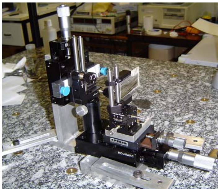
Figura 14: Suporte ótico do sistema de gravação de FBG com máscara de fase contendo: a fibra, a máscara de fase e a lente cilíndrica.
