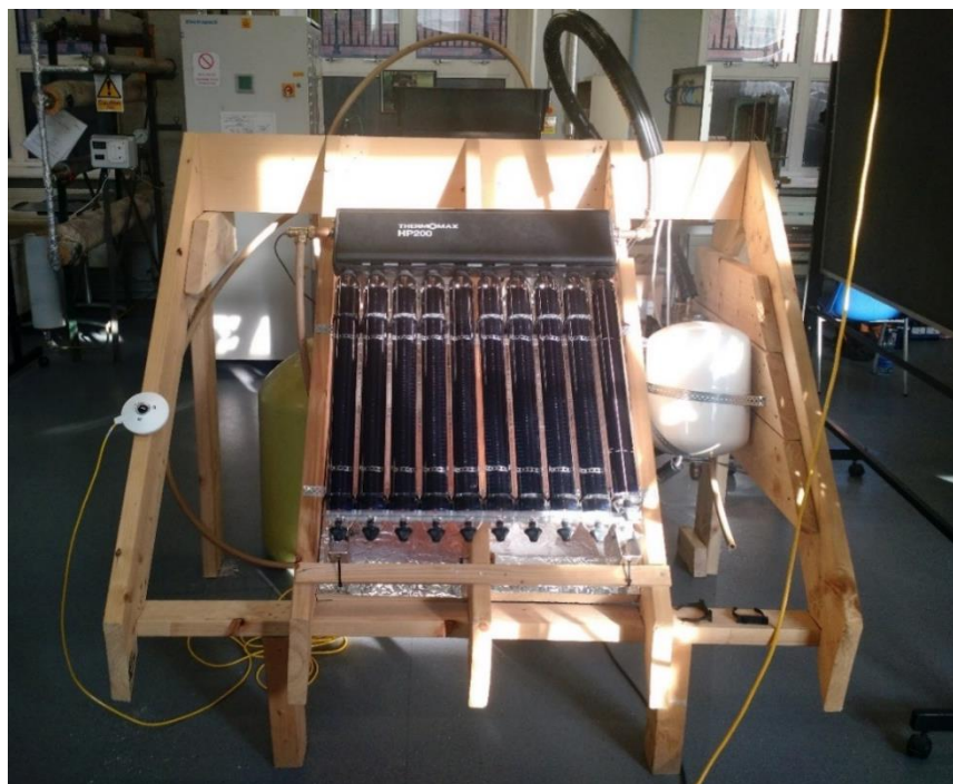
Figura 1 Vista frontal do coletor térmico solar integrado ao telhado
