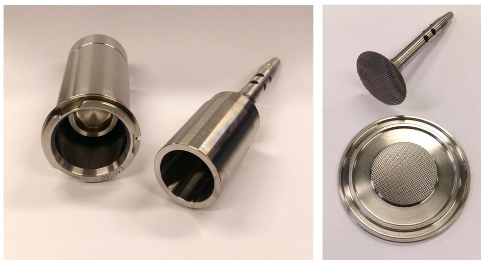
Figura 27 - Cilindros coaxiais com espaçamento duplo (esquerda) e placas paralelas ranhuradas (direita) para o reômetro Haake Mars III
