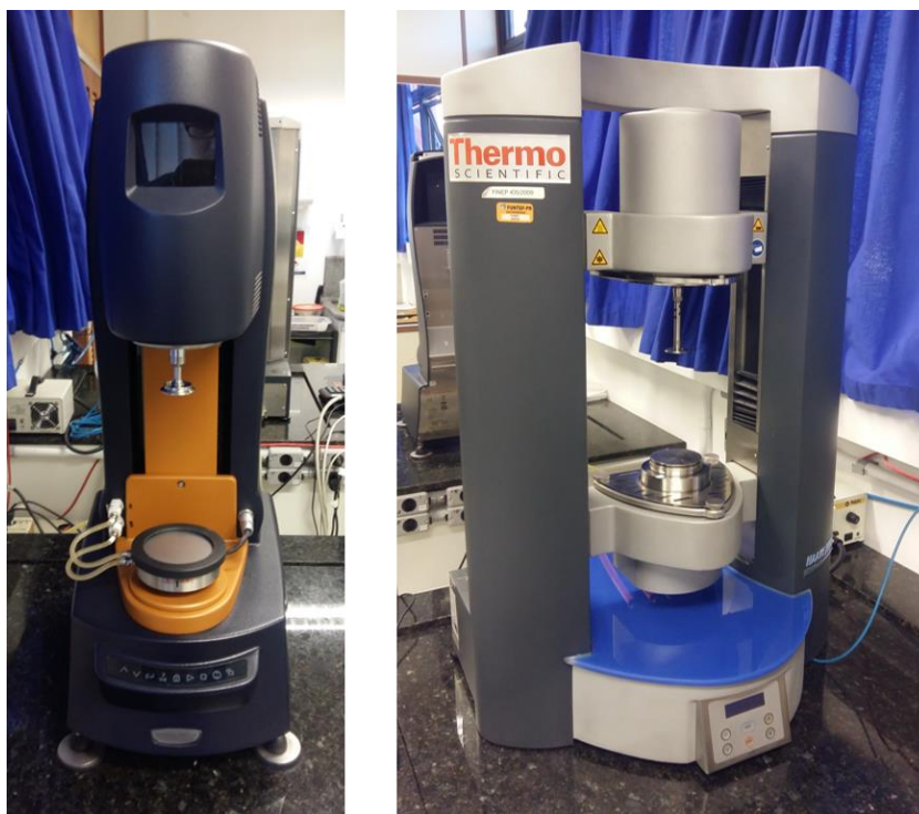
Figura 15 - Reômetros DHR-3 TA Instruments (esquerda) e Haake Mars III Thermo Fisher Scientific (direita) Fonte: A autoria própria (2017)
