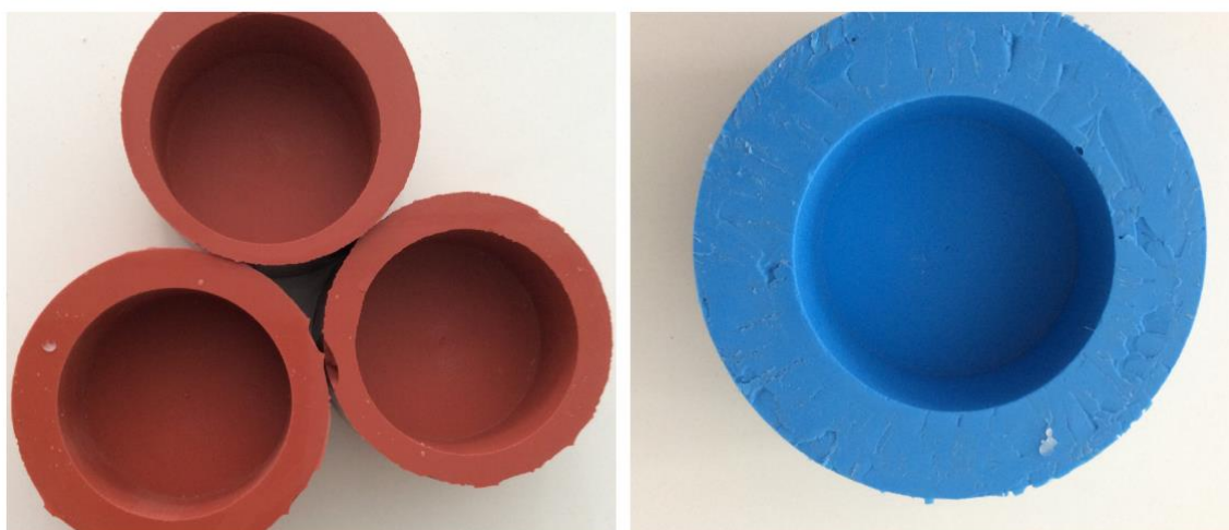
Figura 16 - Moldes de silicone confeccionados para os corpos de prova.
