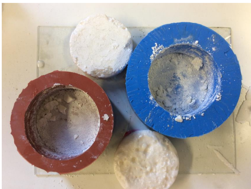
Figura 28 - Imagem da parte dos corpos de prova em contato com o molde, as imperfeições que ficaram são da carga mineral que saiu
