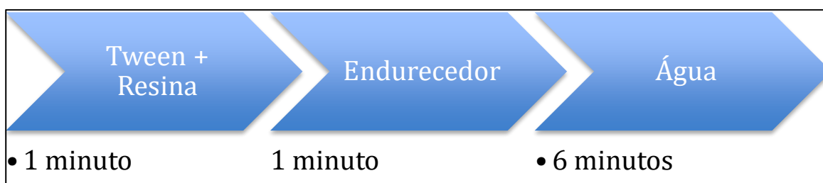
Figura 33 - Sequência adotada para confecção das espumas sem carga mineral
