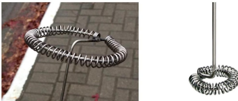
Figura 17 - Hélice confeccionada para adaptar ao equipamento Quimis, à esquerda, e a usada no misturador da Black e Decker M100, à direita
