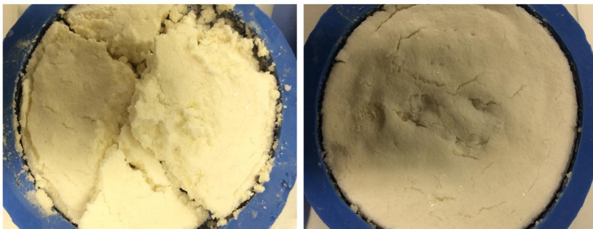
Figura 21 - Corpos de prova da composição C100.30 colapsados após a cura
