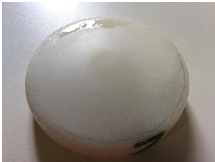
Figura 45 - Corpo de prova após ensaio de compressão
