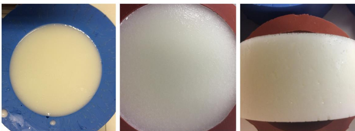
Figura 34 - Corpos de prova da composição C075.10 antes e após a cura
