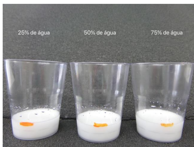
Figura 18 – Aspecto após 24 h das composições de água + resina + agente de cura
