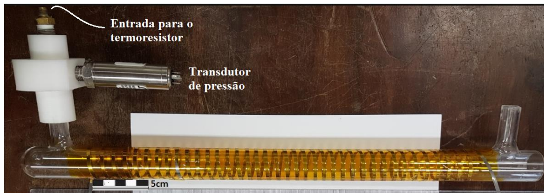
Figura 10. Evaporador do termossifão equipado com o resistor elétrico
