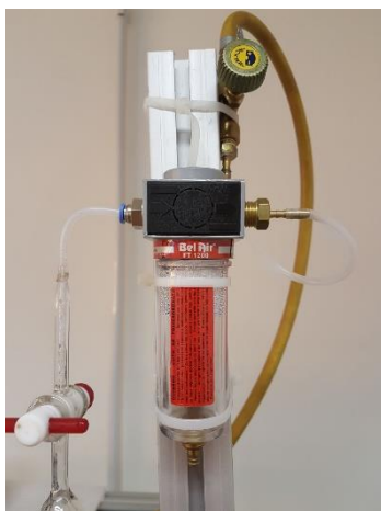
Figura 12. Detalhe do filtro para compressor instalado Fonte: Autoria própria
