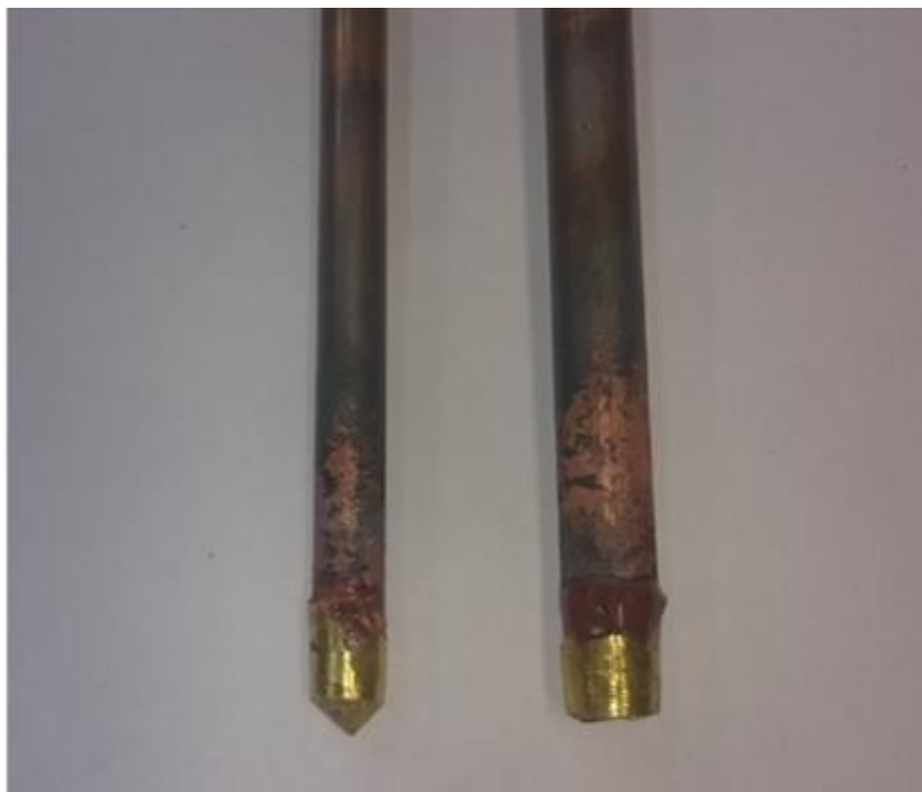
Figura 17: Detalhamento da brasagem com liga de Zn-Cu, realizada na extremidade do evaporador de ambos termossifões.
