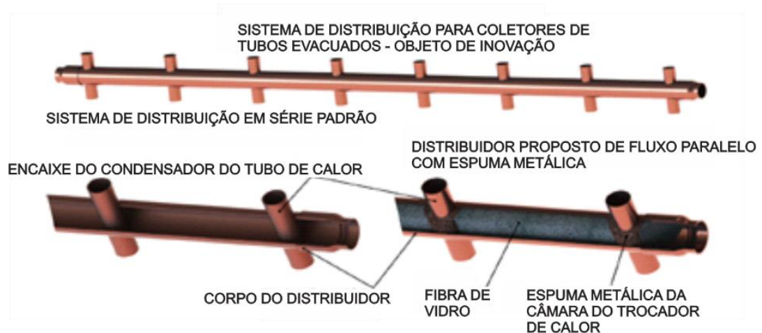
Figura 11: Comparação entre um termossifão comum e o proposto.
