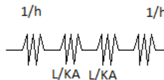
Figura 13 - Resistências térmicas dos fluidos e paredes
