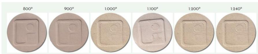
**Figura 28 – Cores obtidas após sinterização**
