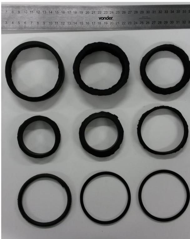
**Figura 25 – Anéis comerciais testados e adaptados no porta amostras**
