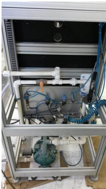
**Figura 18 – Componentes hidropneumáticos da UCLP**
