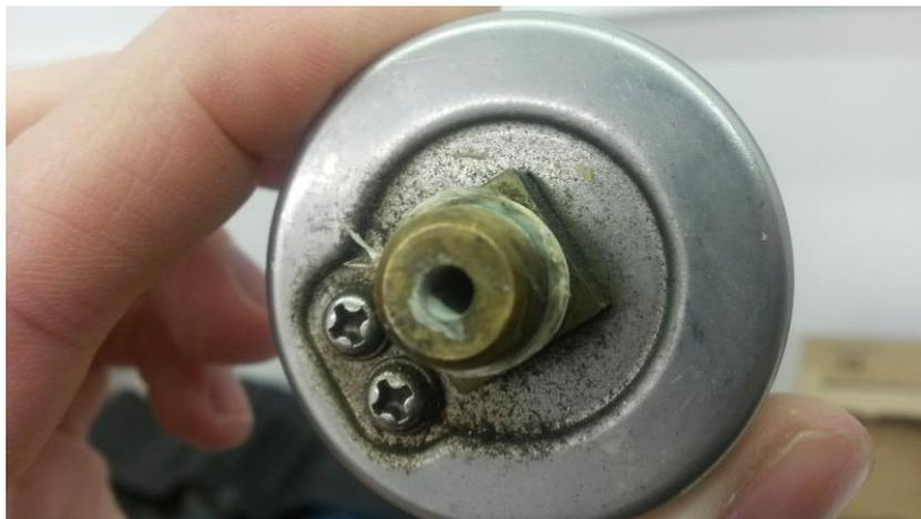
**Figura 38 – Deposição de barbotina solidificada no interior do manômetro**
