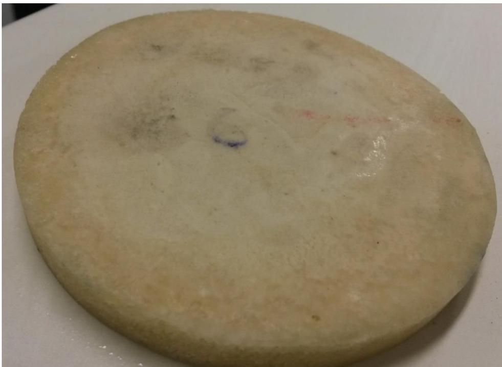
**Figura 36 – Amostra #6 com composição não uniforme**
