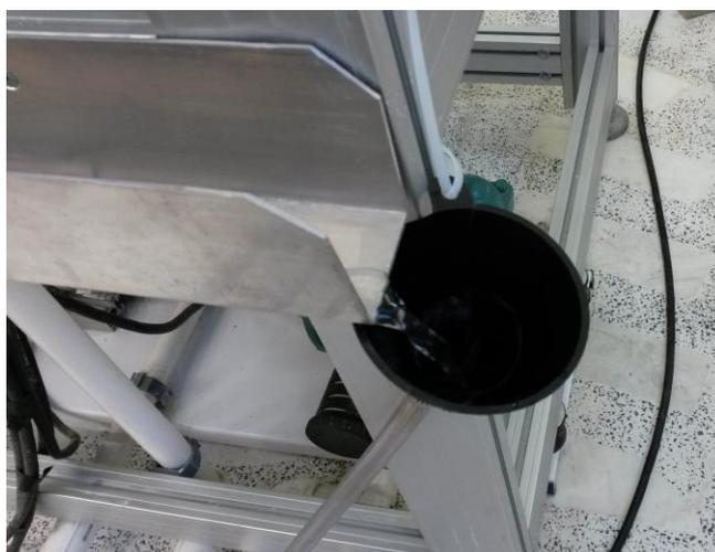
**Figura 42 – Funil coletor de líquidos da calha**
