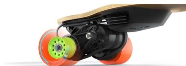
**Figura 20: Sistema de transmissão do Longboard elétrico Boosted Board**
