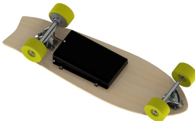
**Figura 57: Caixa dos Componentes Eletrônicos**
