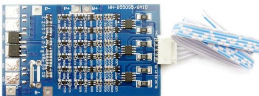
**Figura 27 Sistema de Gerenciamento de Bateria (BMS)**
