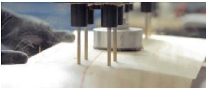
**Figura 5: Processo de furação do *shape***
