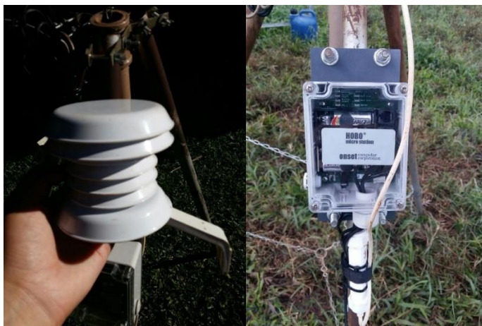
Figura 3.: Datalogger utilizado para coleta de temperatura do ar e umidade relativa do ar.
