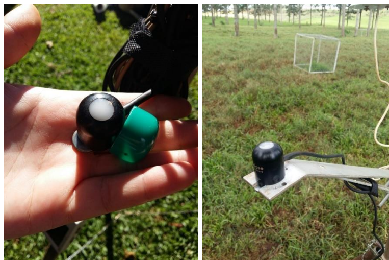
Figura 2.: Sensor Piranômetro SP 212 utilizado para coleta de Irradiância solar global.
