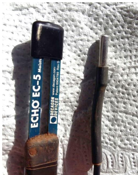
Figura 5.: Sensor termopar para obter temperatura do solo (à direita) e haste ECHO EC-5 para obtenção de umidade do solo (à esquerda).
