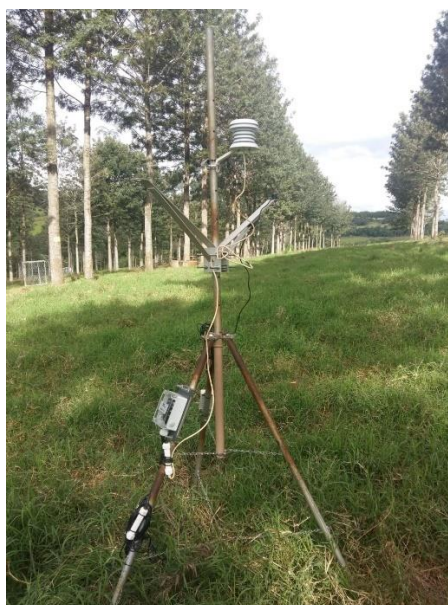
Figura 6.: Microestação meteorológica portátil utilizada para obtenção das variáveis em estudo em sistema silvipastoril.
