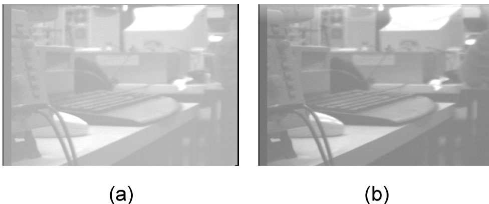
Figura 53 – Imagens adquiridas (a) sem e (b) com deslocamento para o nível de preto óptico
