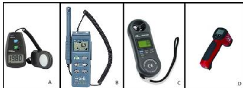
Figura 8 – Equipamentos utilizados para aferir os dados a campo. A) Luxímetro digital; B) Termohigrometro digital; C) Anemômetro digital; D) Termômetro infra vermelho.
