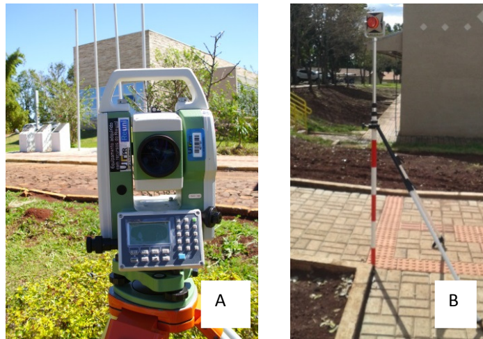
Figura 3 –Equipamentos utilizados para o transporte de coordenadas Legenda: A) Estação Total FOIF® modelo OTS650(L); B) prisma. Fonte: A autora (2013).
