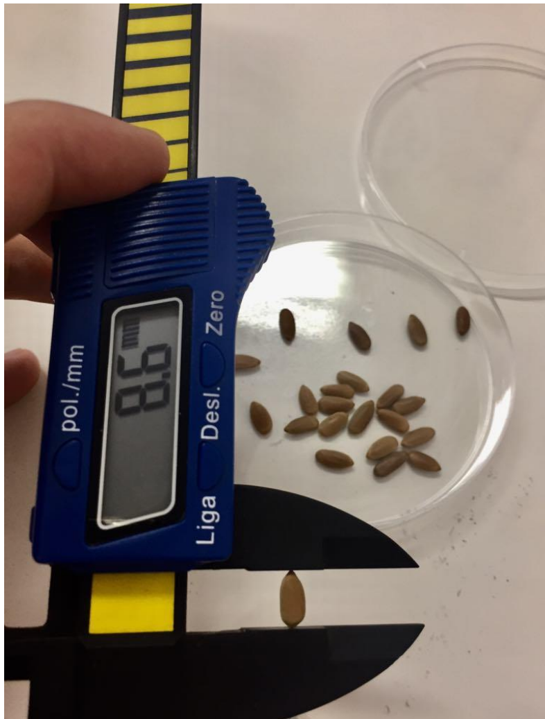
Figura 6: Medição de biometria de sementes utilizando-se paquímetro. Fonte: (O Autor, 2019).
