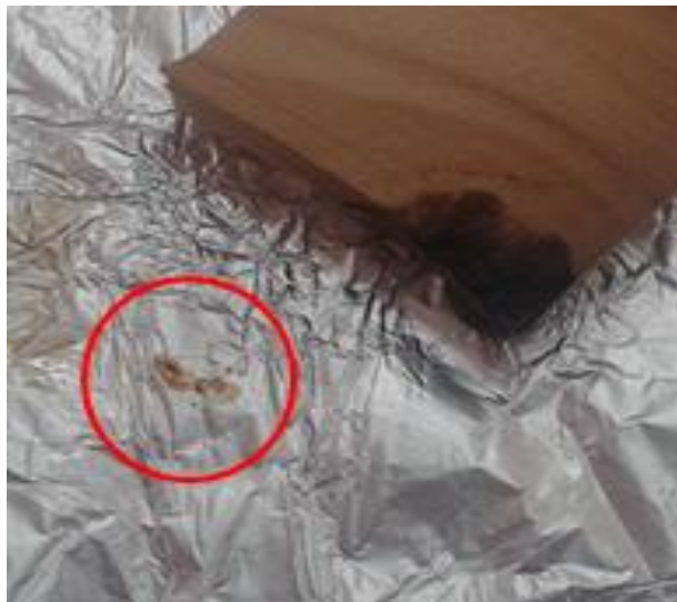
Figura 3 Migração dos extrativos ocorrida durante o tratamento térmico da madeira de Araucaria angustifolia .
