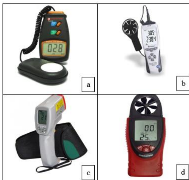
Figura 9: Equipamentos que serão utilizados para mensuração das variáveis; a) luxímetro; b) anemômetro e termômetro; c) termômetro de infravermelho; d) termohigrômetro digital e anemômetro
