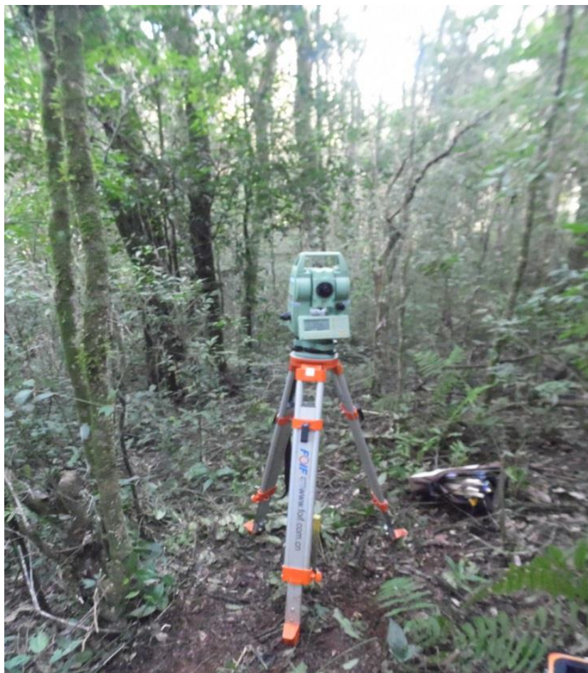
Figura 9: Estação total, instalada e nivelada dentro da floresta. Fonte: Autor (2014)
