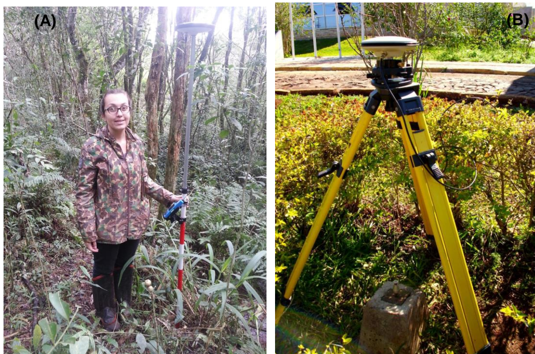
Figura 8: (A)- Receptor topográfico Magellan coletando as coordenadas de uma nascente dentro da floresta. (B)- Receptor geodésico instalado na base da UTFPR-DV.
