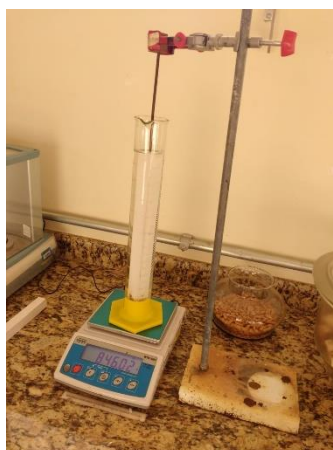
Figura 6 - Pesagem do recipiente mais material submerso. Fonte - Autor (2018).
