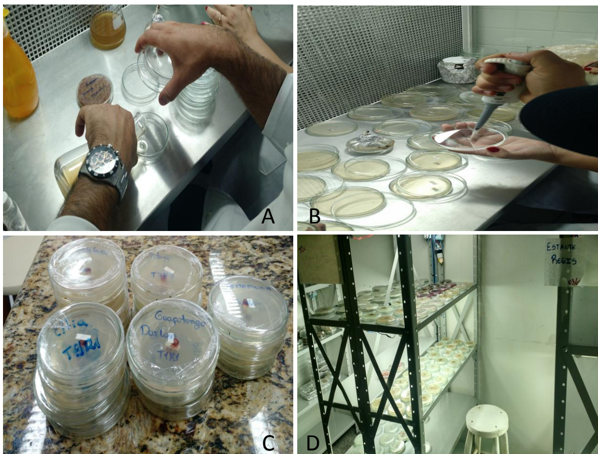
Figura 2: Preparo da placa com BDA para adicionar o fungo (A); adição dos óleos essenciais e dos fungos nas placas (B); placas prontas, identificadas e vedadas (C) e incubação dos placas em sala com temperatura controlada (D). Fonte: O autor, 2015.
