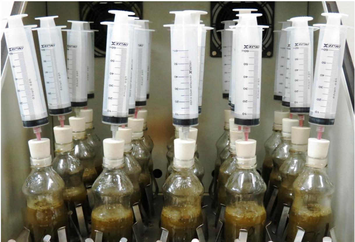
Figura 7 – Reatores em Incubadora *Shaker* durante experimentos do planejamento fatorial.
