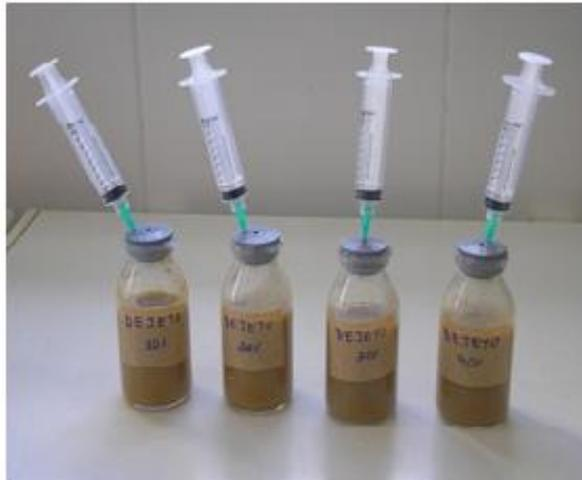
**Figura 4 – Modelo de reatores acoplados com gasômetro (seringa).**
