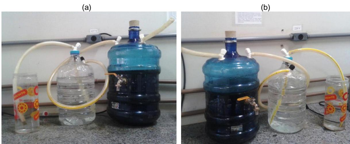
Figura 53 – Biodigestores estudo cinético da codigestão anaeróbia de dejetos suínos e bovinos em batelada para o Biodigestor 1 (a) e Biodigestor 2 (b).
