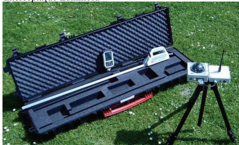
Figura 2- Exemplo do equipamento para medição de Interceptação Luminosa
