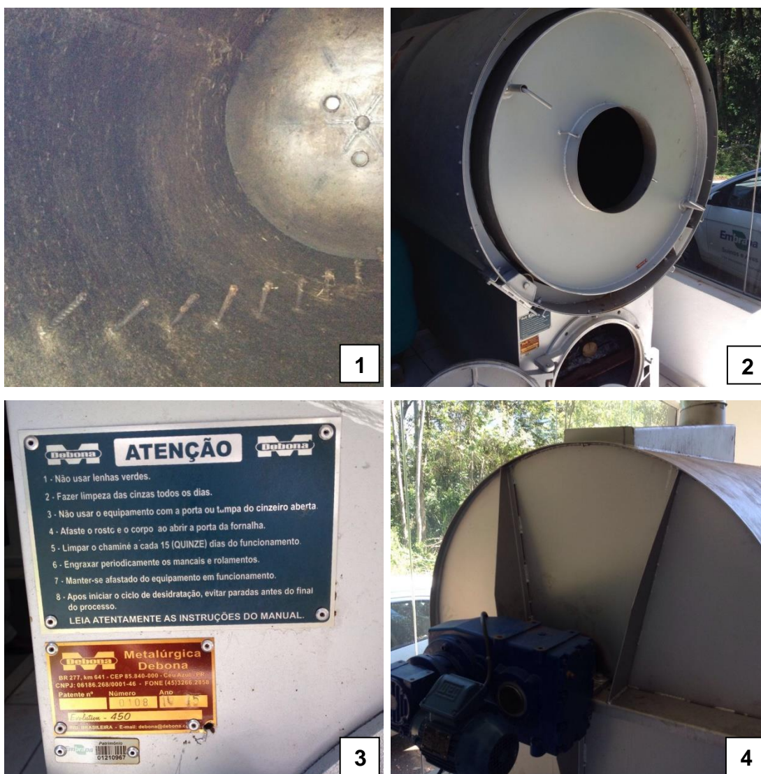
Figura 2 - Interior do desidratador [1]; Visão externa do desidratador [2]; Instruções básicas de operação [3]; Motor de rotação [4].
