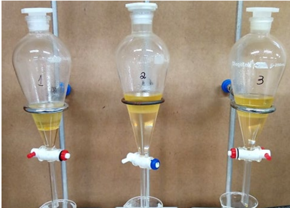
Figura 1 - Separação das duas fases pós filtragem (solvente+ lipídeos e água+ metanol + substâncias não lipídicas).
