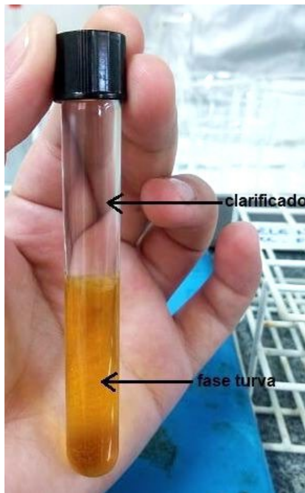
Figura 3 - Mistura reacional de duas fases (clarificada e turva).
