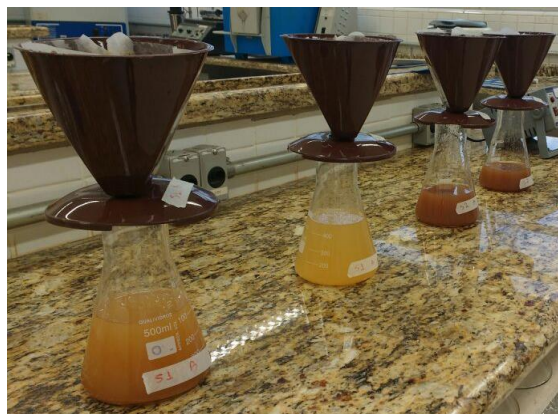
Figura 7: Teste de lixiviação simplificado ocorrido no terceiro dia de experimento.
