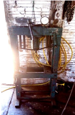
Figura 4 - Vista frontal da prensa manual utilizada
