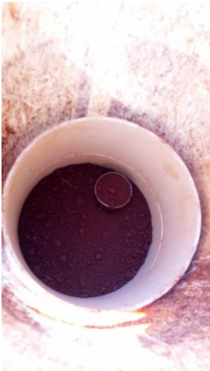
Figura 7 - Anel metálico inserido no anel de PVC.
