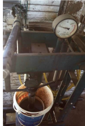
Figura 10 - Vaso de PVC sendo prensado.
