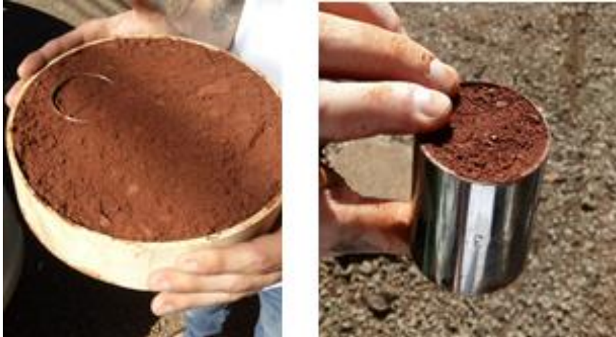
Figura 12 - Anel metálico com o solo compactado.
