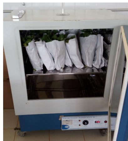
Figura 17 - estufa de secagem para obter a massa seca.
