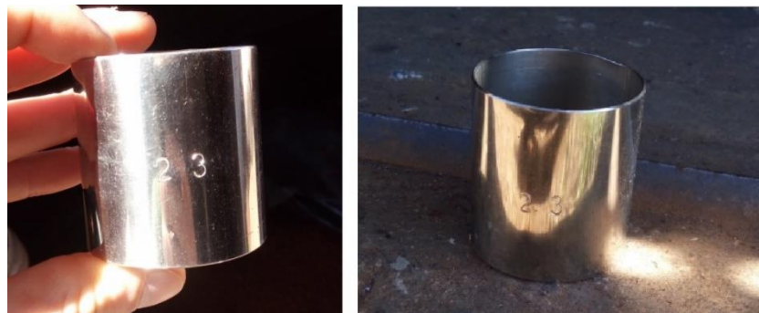
Figura 5 - Cilindro metálico utilizado para amostrar as densidades.
