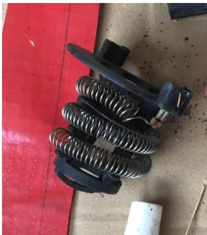
Figura 22 – Resistência de chuveiro encontrado nos rejeitos
