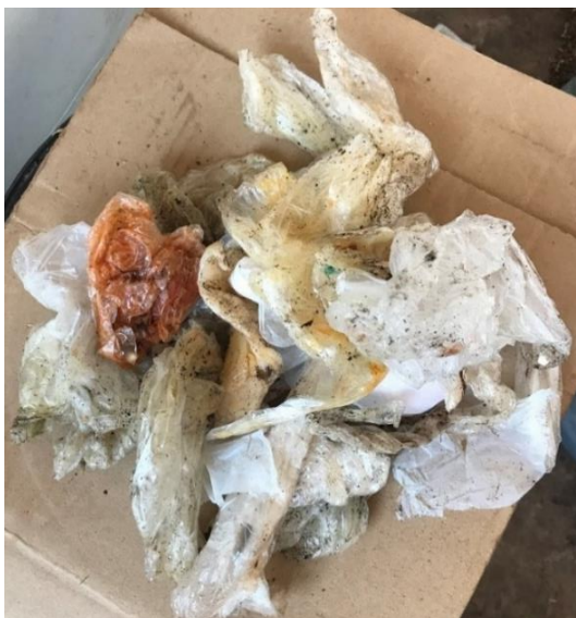
Figura 13 – Sacola e cristais sujos encontrados nos rejeitos
