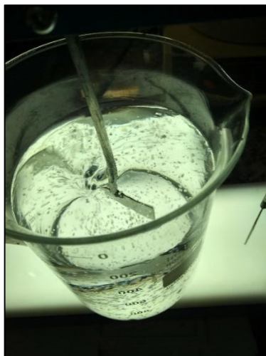
Figura 4 - Preparação do polímero via Jar-Test.
