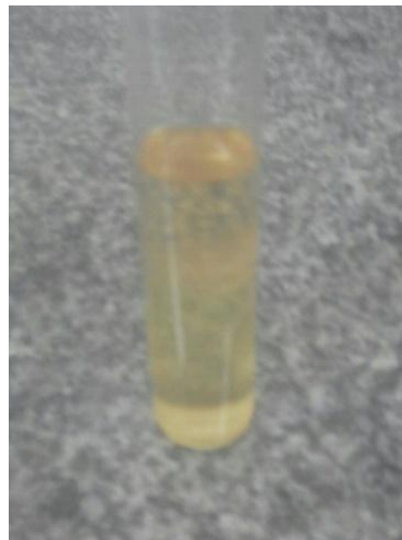
Figura 03- Teste de índice emulsificante com gasolina
