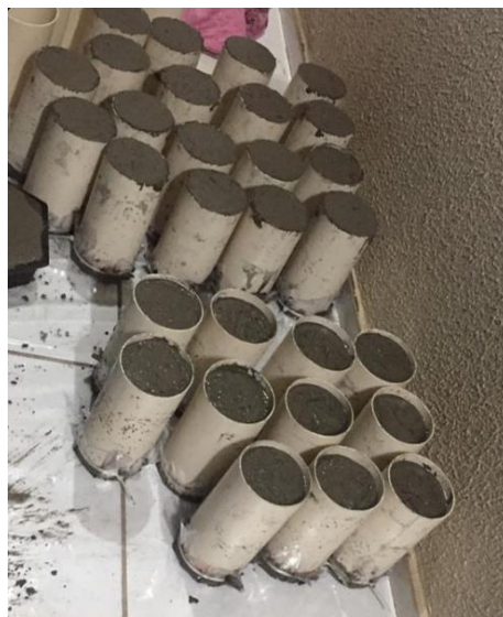
Figura 7 - Moldes de PVC com massa cimentícia
