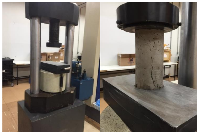
Figura 9 - Prensa do ensaio de compressão com corpo de prova pós ensaio
