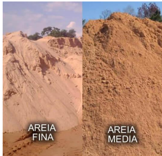
Figura 4 - Areias utilizadas como agregados miúdos
