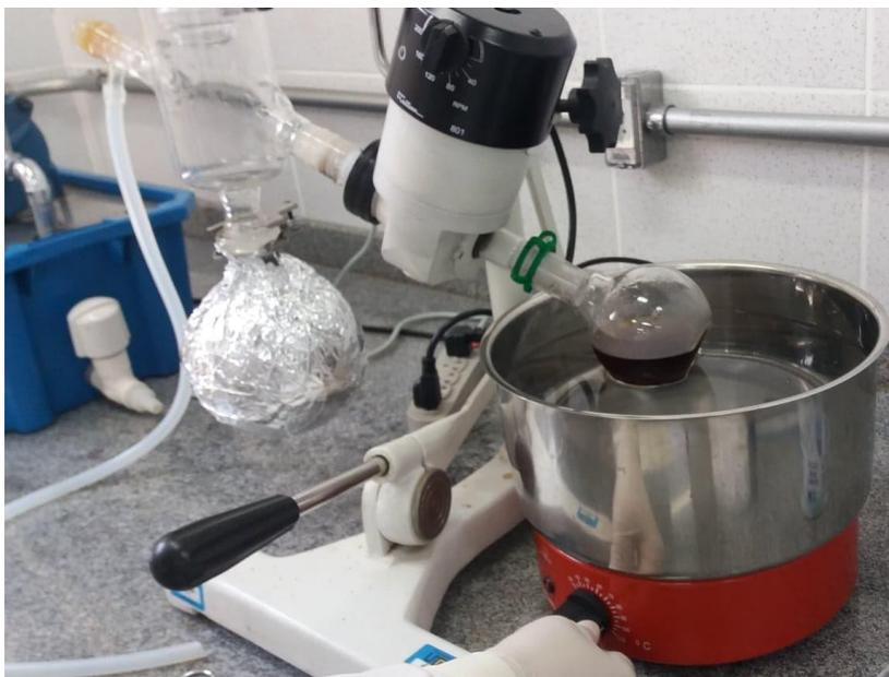
**Figura 12- Rotoevaporador conectado a bomba de vácuo para a destilação do monômero Pi**
