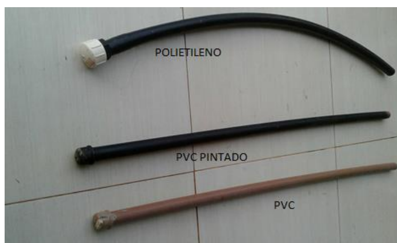
Figura 18 - Tubos prontos para receber água e o termômetro para coleta de dados Fonte O autor, 2018.
