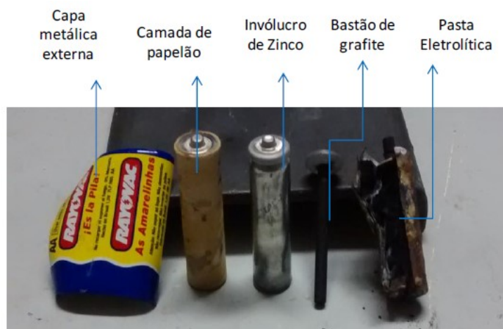
Figura 3 - Desmontelamento das pilhas de zinco/carbono.
