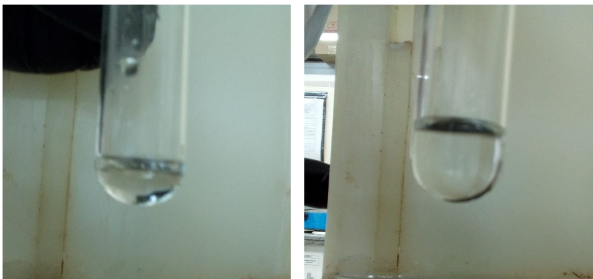
Figura 21 - Teste de Lucas no líquido orgânico (possível etanol) (dir.).
