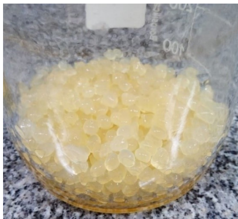
Figura 18 - Beads formulados dentro de frasco Schott vedado sem oxigênio.
