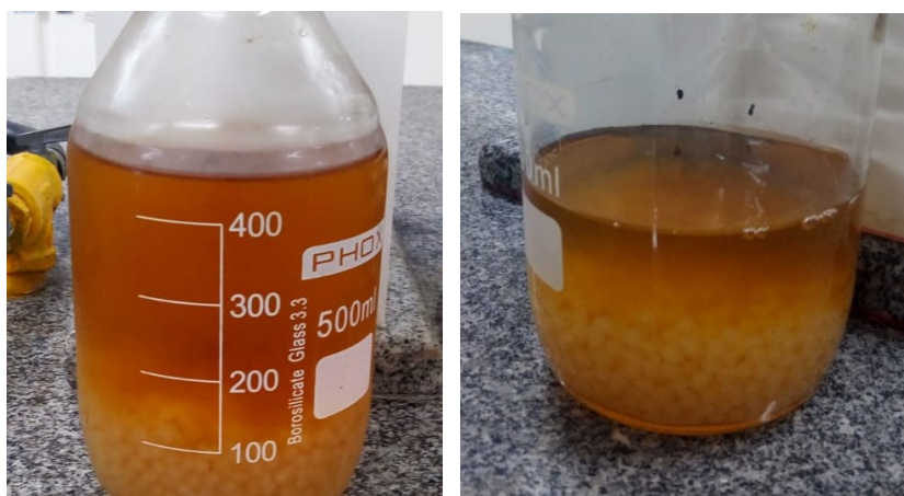
Figura 19 - Frasco com beads fermentado (esq.) e no início da fermentação (dir.).
