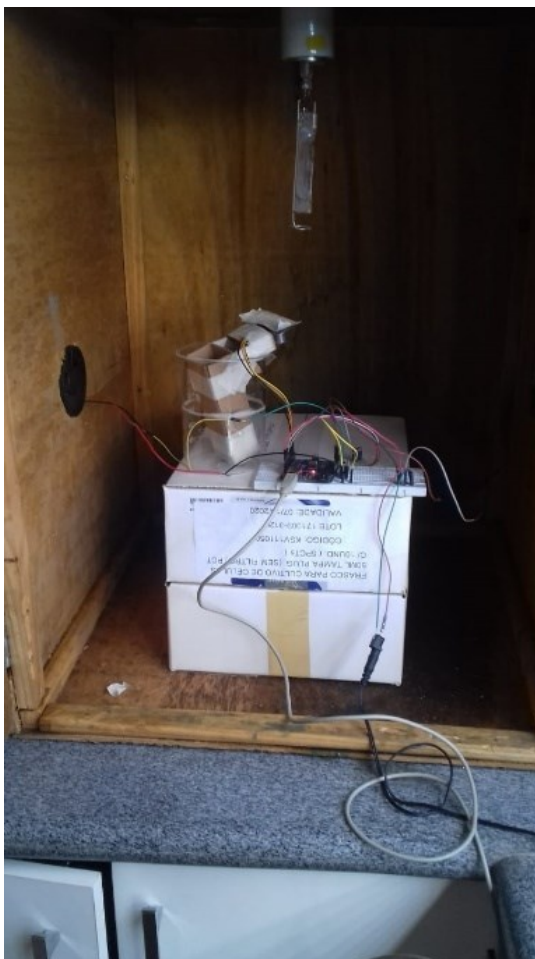
Figura 9 – Sensores e atuadores instalados na estrutura de coleta de dados
