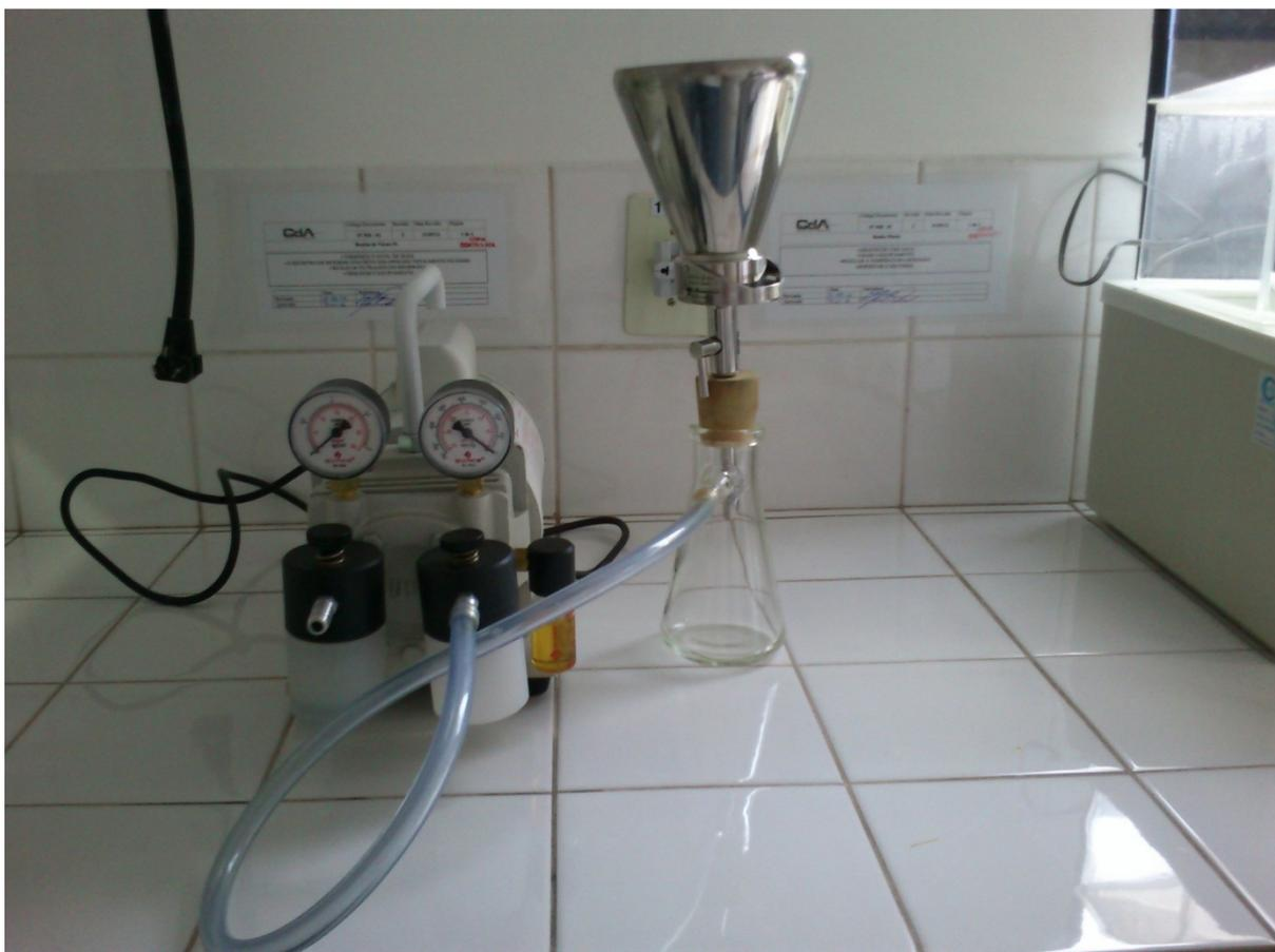
Fotografia 1 – Sistema filtrante, usado para análises de coliformes totais e termotolerantes em água.
