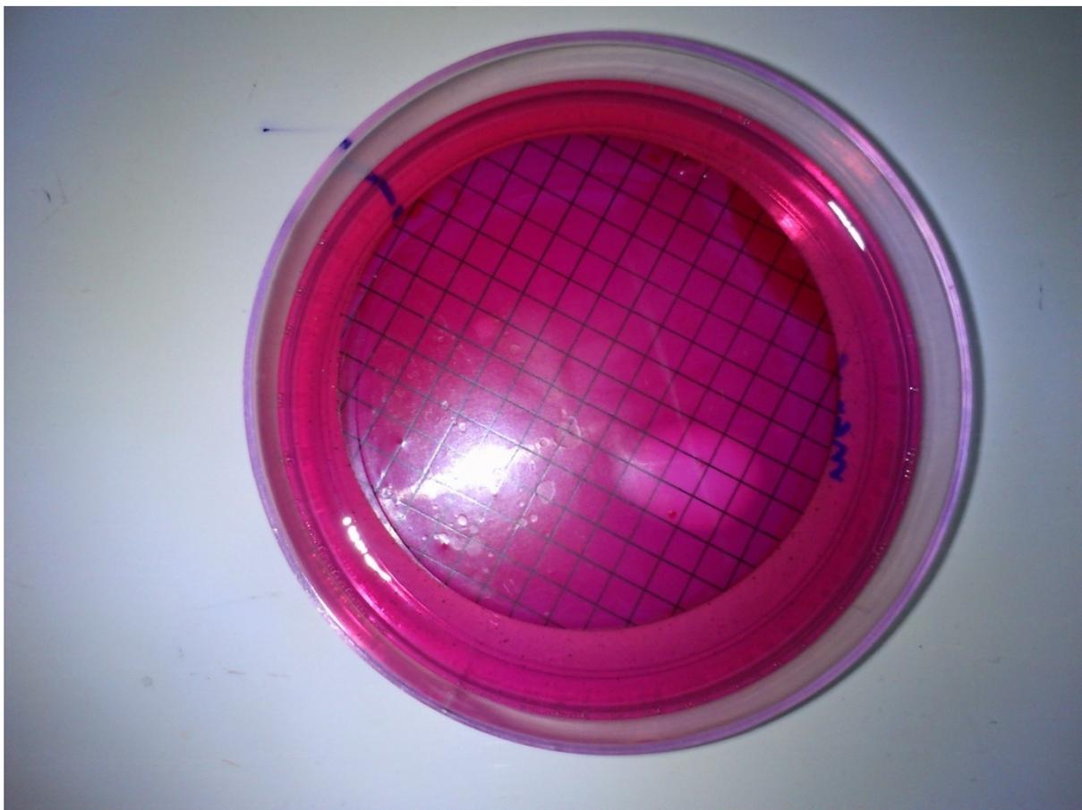
Fotografia 2 – Placa de Agar M-endo com membrana filtrante.
